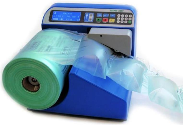
La macchina Mini Air Professional è la soluzione ideale per tutti coloro che necessitano abitualmente di **cuscini ad aria** per colmare gli spazi vuoti all'interno delle scatole oppure **di tappeti ad aria** per proteggere i prodotti all'interno delle scatole.
