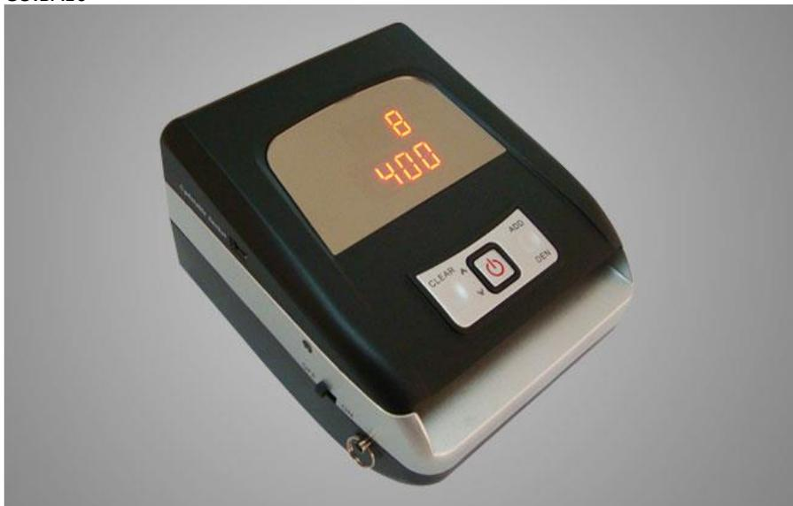
L'acquisto di questo prodotto di qualità rappresenta un'ottima scelta. Con le funzionalità di verifica del filo di sicurezza, magnetismo ed infrarossi, CO.BA10 e offrono uno standard di sicurezza elevato per il controllo delle banconote. Per un funzionamento privo di errori e anomalie, leggere attentamente le istruzioni d'uso.
